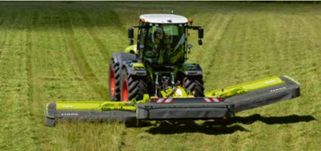
Elevación individual de las unidades segadoras en cabeceras.
