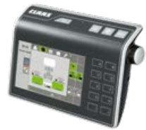
CEMIS 700. Terminal ergonómico, compatible con ISOBUS, con manejo táctil, con teclas o con botón selector rotativo.
