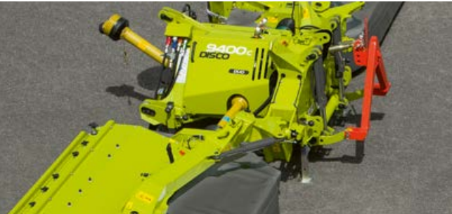
Machine protégée par la sécurité anticollision non-stop hydraulique en cas de choc avec pivotement et remise automatique en position initiale de l'unité de fauche
