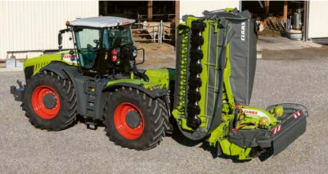
Gabarit compact en position de transport
