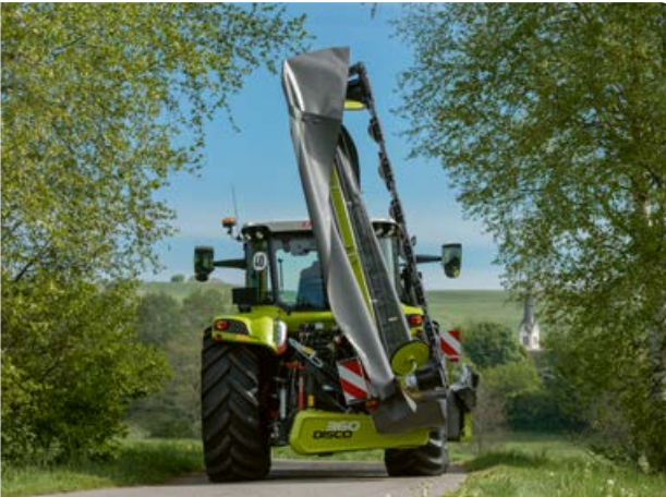
Smalle transportbreedte en vrij zicht naar achteren: in de transportstand van 105° bent u met de DISCO 100 veilig onderweg op de weg.
