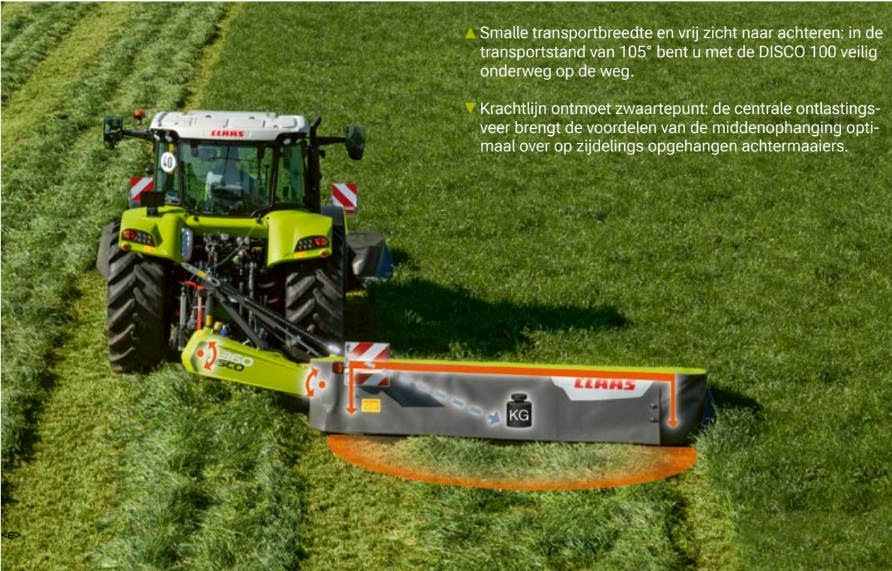
Met de juiste kneuzer verkort u de droogtijd van het gemaaid gewas aanzienlijk. Extra zwadschijven aan de buiten- en binnenkant optimaliseren de zwadvorm.
