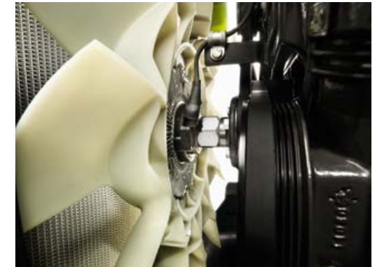
▲ La régulation électronique du ventilateur Visctronic adapte avec précision le régime du ventilateur de refroidissement en fonction des conditions, diminuant ainsi le niveau sonore et la consommation de carburant.
