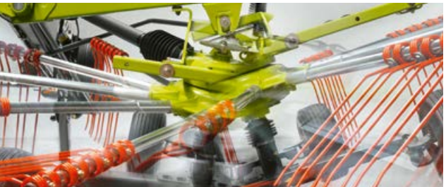
Kardanische Kreiselauflängung: Die Kreisel passen sich dem Boden an – unabhängig vom Traktor.
