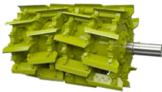
▲ Halbmesserbestückung für doppelte Schnittlänge und sehr ruhige, homogene Erntegutabgabe.
