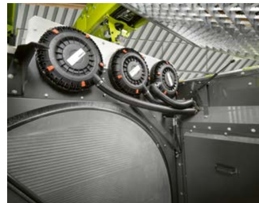
▲ Drei Luftfilter versorgen zuverlässig den leistungsstarken Motor. Für eine schnelle Wartung sind sie werkzeuglos zugänglich.
