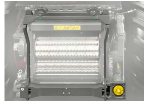
▲ Der Pendelrahmen sorgt aktiv (hydraulisch) oder passiv (Schwimmstellung) für einen geregelten Seitenausgleich, um die Vorsatzgeräte optimal dem Boden anzupassen.
