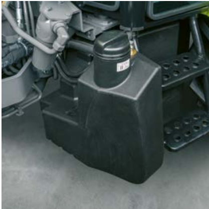
Der 105-l-Dieseltank und der 10-l-Harnstofftank bieten selbst an langen und intensiven Arbeitstagen ausreichend Reichweite.
