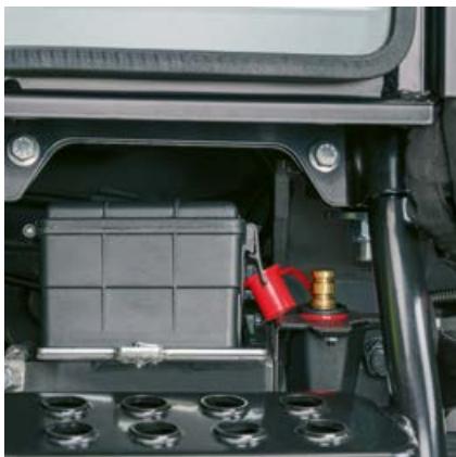
ELIOS 3 vi facilita il lavoro quotidiano con numerose soluzioni intelligenti come, ad esempio, lo spostamento dei poli della batteria sul lato destro della cabina.
