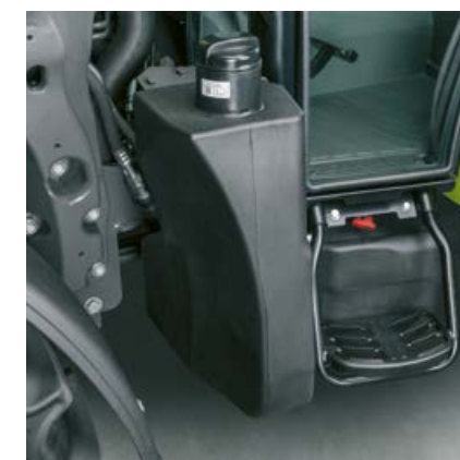
Zbiornik oleju napędowego 95 l i zbiornik moczownika 10 l zapewniają wystarczający zasięg nawet w długie i intensywne dni pracy.
