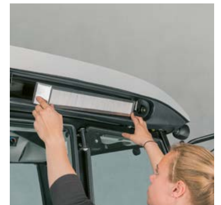
Filtr powietrza kabiny jest łatwo dostępny z zewnątrz do czyszczenia i zawsze zapewnia świeże powietrze w kabinie.
