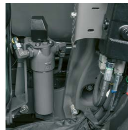
Filtr silnika jest dobrze dostępny także z konsolą ładowacza czołowego.
