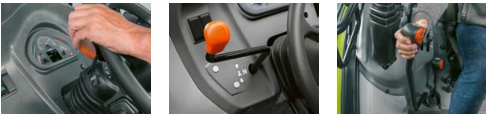
L'inversore meccanico o l'inversore elettro-idraulico REVERSHIFT sono posizionati comodamente a sinistra del volante.
