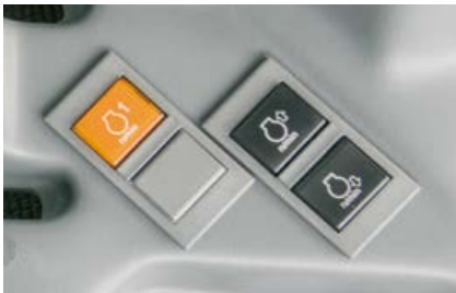
Con ELIOS 2 si possono eseguire in modo semplice le operazioni con la presa di forza grazie alla memoria regime motore di serie.
