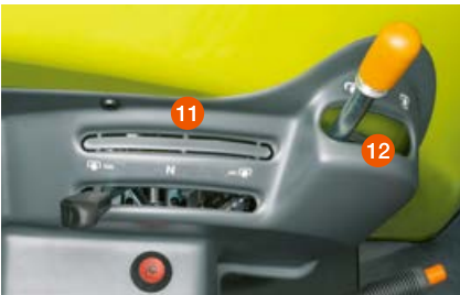
L'innesto della presa di forza è supportato idraulicamente. Sui trattori dotati di REVERSHIFT l'innesto elettronico della presa di forza è disponibile in opzione.
