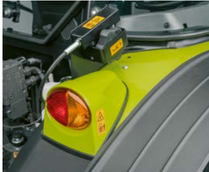
El reglaje mecánico del elevador trasero puede ser manejado externamente en la parte trasera para el montaje de implementos.
