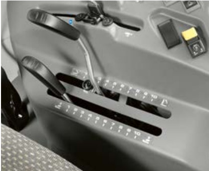
El manejo del reglaje mecánico del elevador trasero está colocado, de manera ergonómica, a la derecha, junto al asiento del operario.
