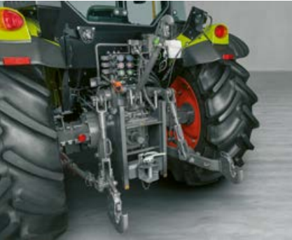
Con una capacidad de carga máxima de 3,2 t el ELIOS 2 se enfrenta sin problemas a los duros quehaceres diarios.
