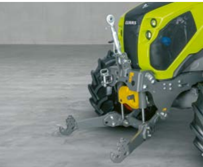
El elevador delantero opcional con 3,2 t de capacidad de carga y la toma de fuerza delantera amplían la gama de usos del ELIOS 2.
