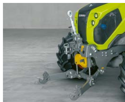
Le relevage avant de 3,2 t en option et la prise de force assurent la polyvalence de l'ELIOS Série 2.
