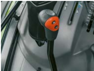
Vous disposez au choix d'un doubleur mécanique à droite du volant ou d'un doubleur sous charge TWINSHIFT qui se commande avec le levier de vitesses.
