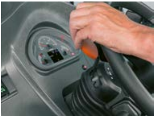
Situé à portée de main à gauche du volant, l'inverseur est commandé au choix de façon mécanique ou électro-hydraulique avec le REVERSHIFT.
