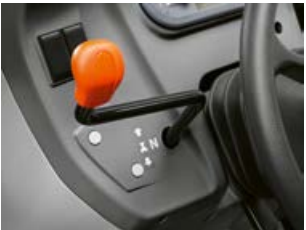
Situé à portée de main à gauche du volant, l'inverseur est commandé au choix de façon mécanique ou électro-hydraulique avec le REVERSHIFT.
