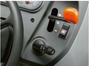
Vous disposez au choix d'un doubleur mécanique à droite du volant ou d'un doubleur sous charge TWINSHIFT qui se commande avec le levier de vitesses.
