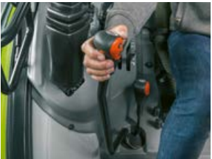
Avec REVERSHIFT : commande de l'embrayage électro-hydraulique par simple pression sur un bouton du levier de commande.
