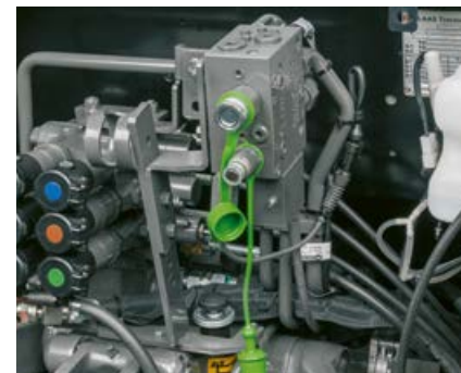
Mit der hydraulischen Zweileitungsanhängerbremse bleiben Sie auch bei Transporten flexibel.
