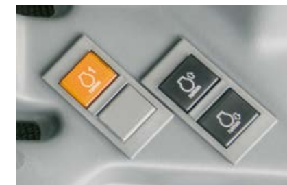
Zapfwellenarbeiten erledigen Sie mit dem ELIOS 2 besonders einfach – dank des serienmäßigen Motordrehzahlsspeichers.
