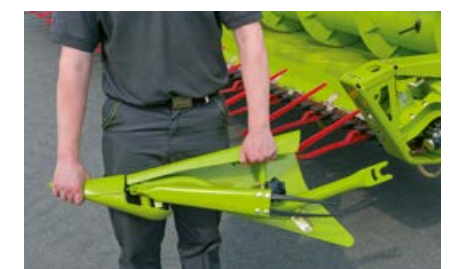
Gli sparticampo si sostituiscono rapidamente.
