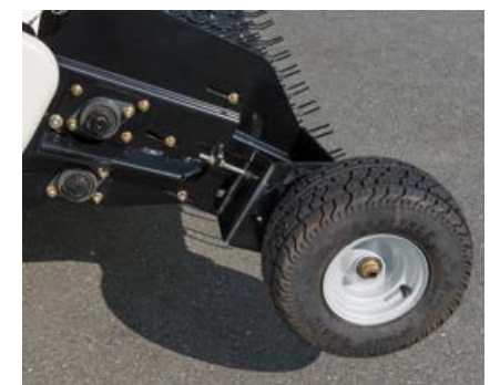
La profondità di lavoro è regolabile tramite le ruote tastatrici.
