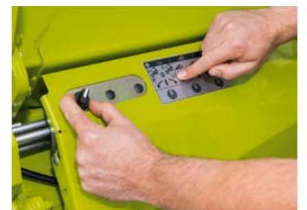
Regolazione della posizione di stazionamento e pulizia direttamente sulla piattaforma di taglio
