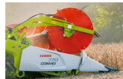
Sparticampo su supporto elastico per la raccolta di prodotti che crescono in prossimità del suolo.
