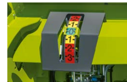
La posizione corrente della lama di taglio è ben visibile dalla cabina.
