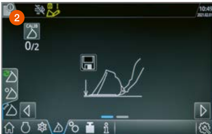
Die Schaufelrückführung fährt zwei gespeicherte Schaufelpositionen automatisch an.
