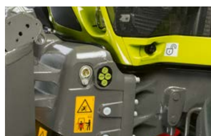
Externe Bedienung für den Frontkraftheber und ein Steuergerät (ausstattungsabhängig)
