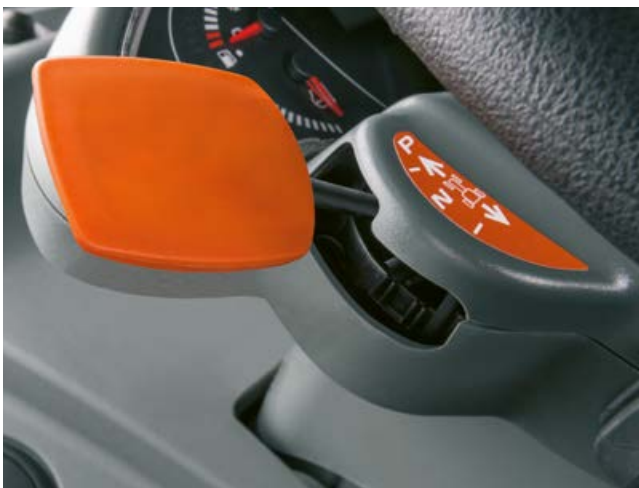
REVERSHIFT Wendeschalthebel mit elektronischer Feststellbremse verfügbar
