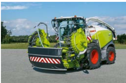
Ribaltamento rapido dalla posizione di trasporto alla posizione di lavoro e viceversa.
