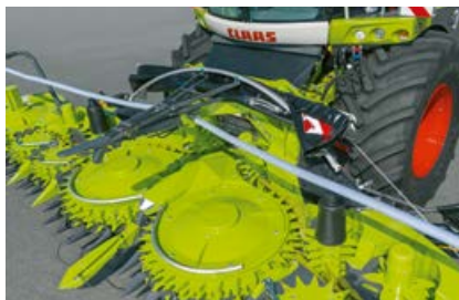
Collocazione compatta con vista illimitata sulla ORBIS durante la raccolta. La protezione trasporto, riposta in sicurezza, rimane a bordo della macchina.
