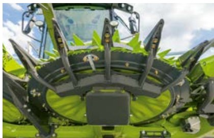
Robuste dita convogliatrici e raschiatori sotto il disco di taglio per un lavoro pulito.
