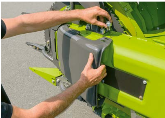
Slitte con regolazione dell'altezza su due livelli.
