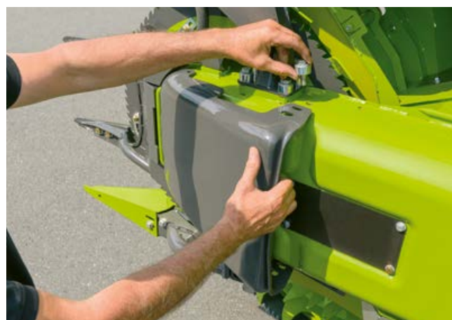
Скользящие башмаки с двухступенчатой регулировкой по высоте.
