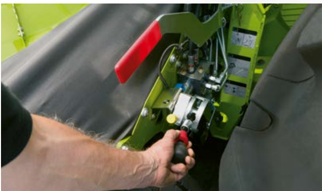
Adaptación en tres niveles del régimen de revoluciones de los cilindros de alimentación para un flujo de material óptimo.
