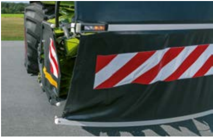
La protección delantera y las laterales se ven perfectamente con los adhesivos de advertencia. La iluminación LED está totalmente integrada
