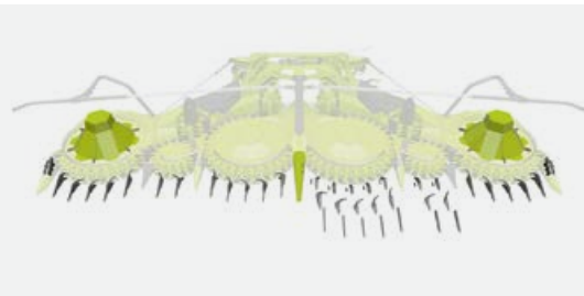
Les cônes et les vis (à entraînement hydraulique) pour maïs versé sont des équipements supplémentaires.
