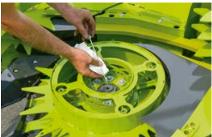
Bagnet pomiarowy do kontroli oleju.
