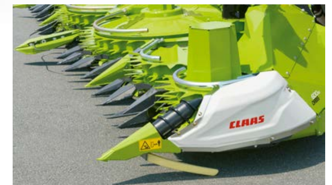
W razie potrzeby napęd ślimaków do wylęgłej kukurydzy jest zasilany hydraulicznie.
