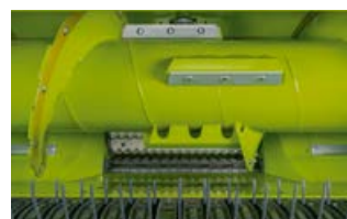
Akcesoria: gładkie listwy osłaniające ślimaka wciągającego oraz duża rolka podporowa
