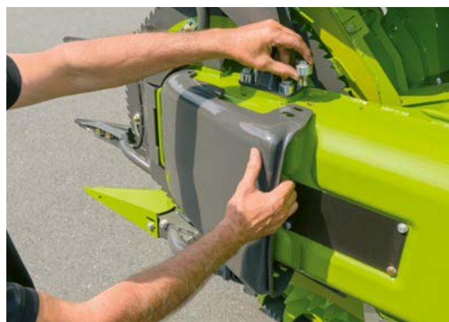
Płozы ślizgowe z dwustopniową regulacją wysokości.
