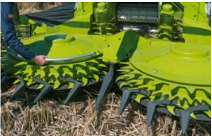
Demontage der Kolbenfallen erhöht die Gutflusstauglichkeit.
