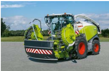
Schneller Klappvorgang von Transport- in Arbeitsstellung und umgekehrt.
