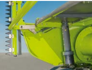
Einstellbare Niederhalter, optional auch hydraulisch.
