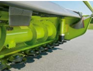
DIRECT DISC 600 / 500 mit groß dimensionierter Einzugschnecke.
