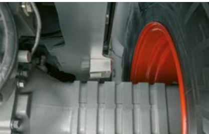
Per consentire l'utilizzo di pneumatici particolarmente alti, adatti agli impieghi agricoli, è possibile limitare l'oscillazione dell'asse posteriore.
