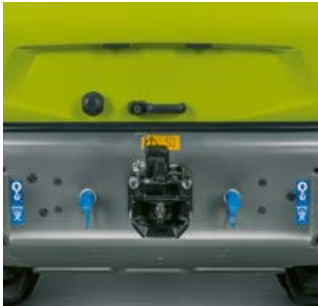
Nella parte posteriore si trovano due attacchi rapidi idraulici supplementari.
