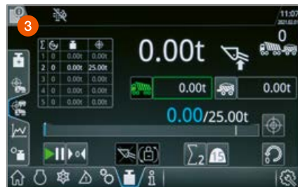
Il sistema di pesatura misura e documenta con precisione la quantità movimentata durante la giornata.
