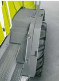
Sur toutes les TORION de la gamme moyenne, toutes les ailes sont réglables départ usine afin d'améliorer la visibilité sur les roues, en particulier lors du travail le long des parois du silo.
