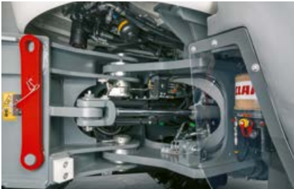
L'articulation avec un angle de 40° rend la TORION maniable et agile.
