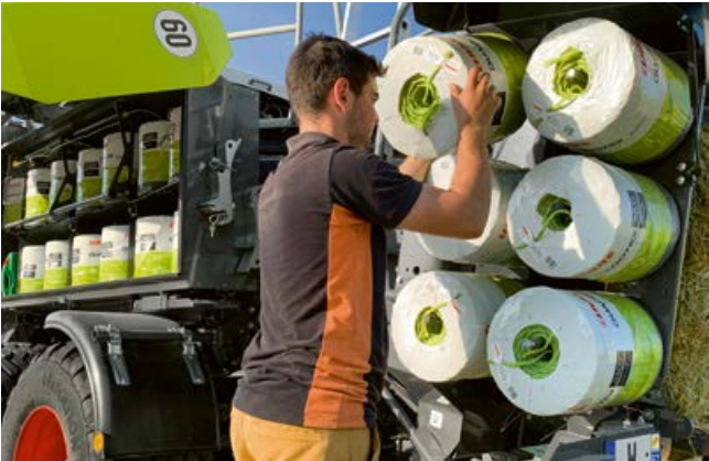
Опція: місце для 12 додаткових котушок шпагату. Залежно від розміру котушки цього вистачає на 350—400 спресованих тюків.
