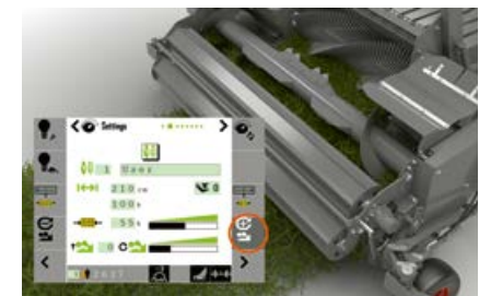
POWER FEEDING SYSTEM легко перемикається в режим реверсу з кабіни оператора.
