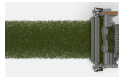
Підбирач, PFS і роликові притискачі забезпечують оптимальний потік рослинної маси.
