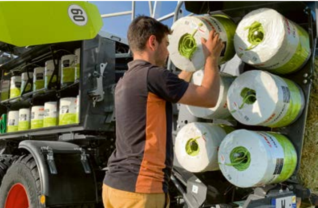
In opzione: spazio per 12 rotoli di spago addizionali. A seconda delle dimensioni del rotolo, si possono legare 350-400 balle pressate.
