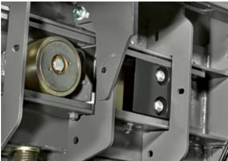
Поворотные ножи устанавливаются в двух положениях для использования для соломы / кукурузной соломы или сена/силоса.
