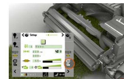
POWER FEEDING SYSTEM można rewersować łatwo z kabiny operatora.
