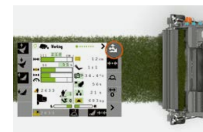
Wciąganie hydrauliczne PFS daje się wygodnie ustawić z kabiny ciągnika.
