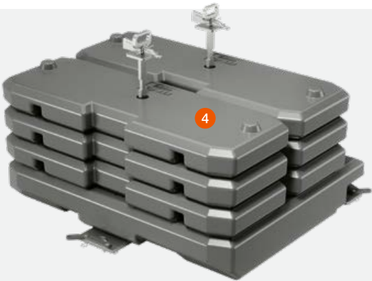
Możliwość balastowania z tyłu do 3400 kg.
