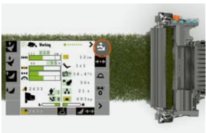
L'alimentation hydraulique PFS peut être paramétrée confortablement depuis le siège du tracteur.
