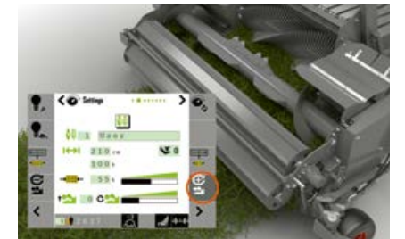
Das POWER FEEDING SYSTEM ist aus der Fahrerkabine heraus leicht reversierbar.
