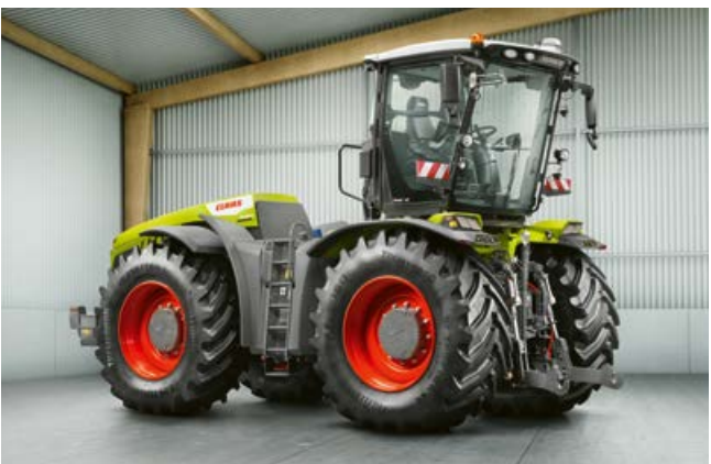
El TRAC VC dispone del dispositivo de marcha atrás más confortable del mercado. Su cabina se puede girar en menos de 30 segundos en 180°.
