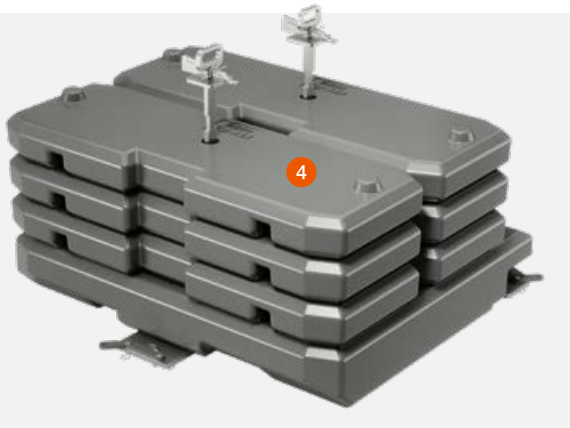
Ballastierung am Heck mit bis zu 3.400 kg möglich.
