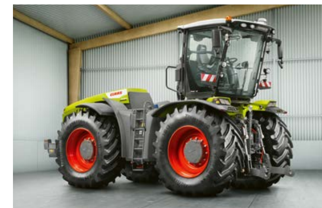
Der TRAC VC verfügt über die komfortabelste Rückfahreinrichtung auf dem Markt. Seine Kabine lässt sich in weniger als 30 Sekunden um 180° drehen.
