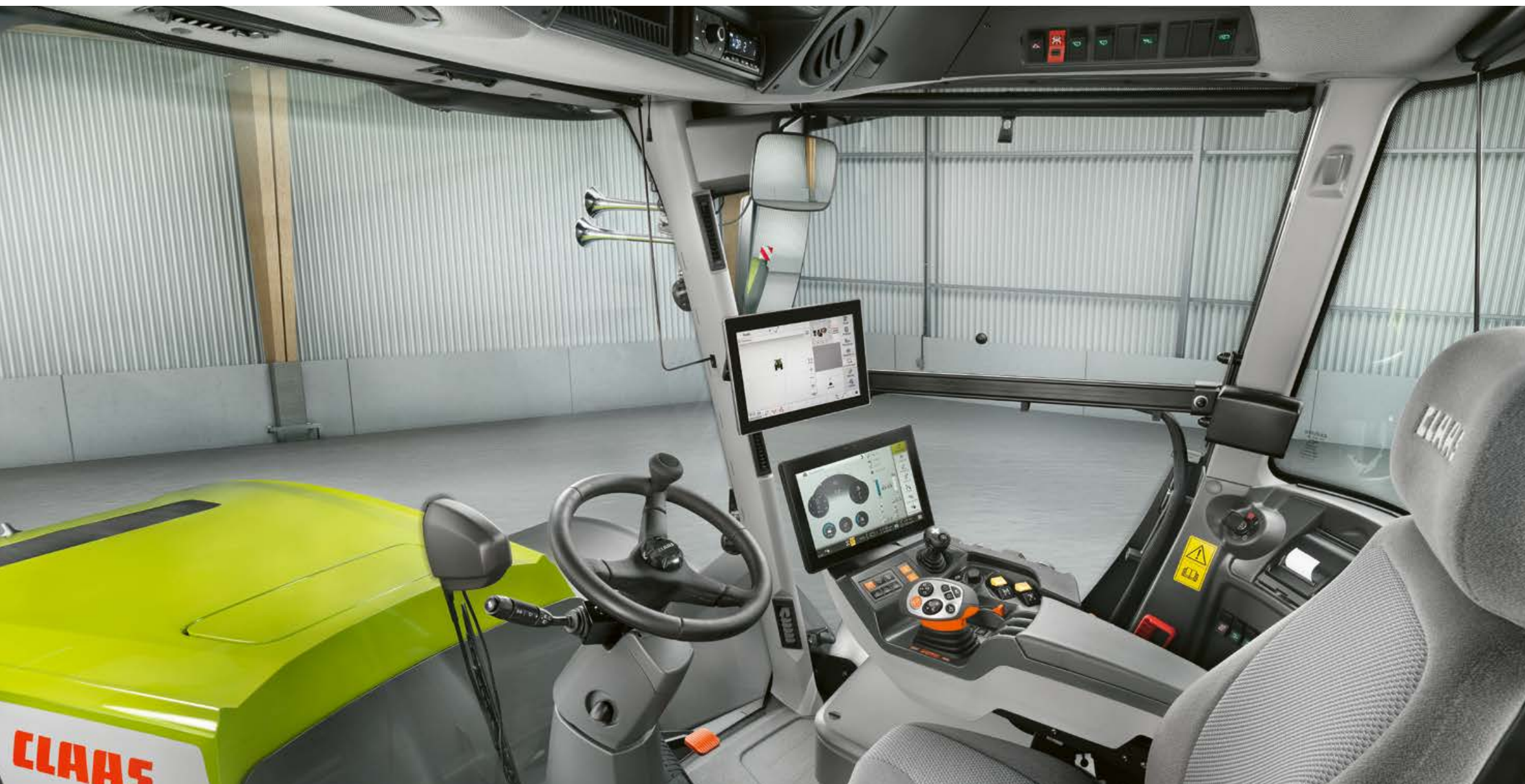
Der TRAC VC verfügt über die komfortabelste Rückfahreinrichtung auf dem Markt. Seine Kabine lässt sich in weniger als 30 Sekunden um 180° drehen.
