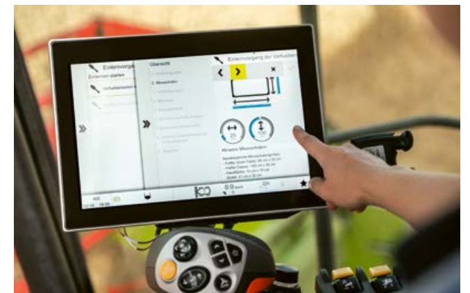
Immissione nel CEBIS delle dimensioni della vaschetta di perdita in dotazione.
