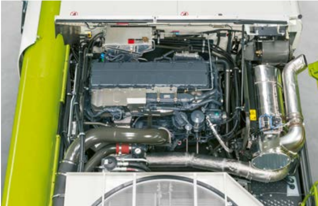
MAN D42 da 581 kW / 790 CV per LEXION 8900 / 8800.
