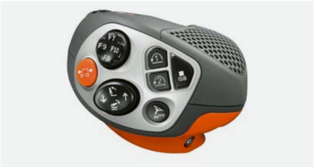
Алгоритмы активируются с помощью функциональных клавиш на рычаге CMOTION.
