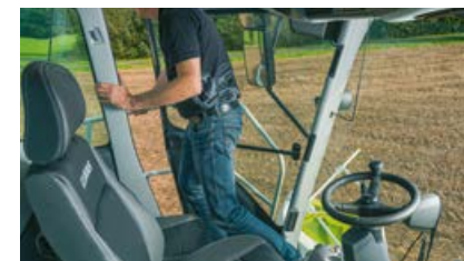
Der Sitzschalter schaltet Vorsatz und Hauptantrieb automatisch aus.
