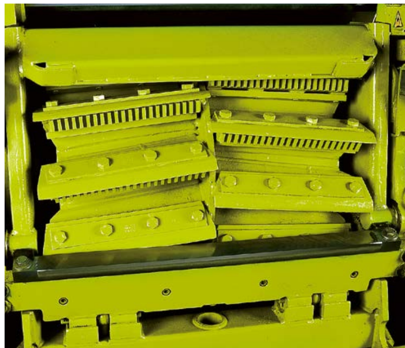
Микробичи под ножами для дополнительной обработки убираемой культуры
