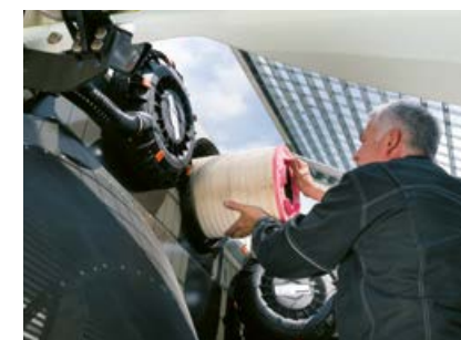
Замена воздушного фильтра без использования инструментов
