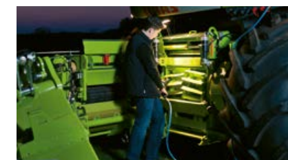
QUICK ACCESS обеспечивает проверку органов измельчения в течение нескольких минут.
