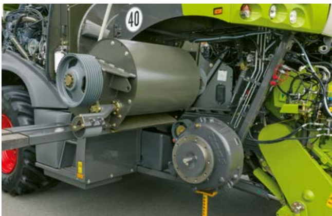
Простой монтаж и демонтаж ускорителя
