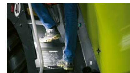
Светодиодная подсветка ступеней обеспечивает безопасный подъем в комфортабельную кабину.
