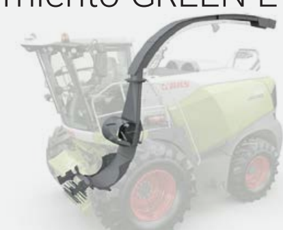
Flujo de material PREMIUM LINE con contracuchilla
