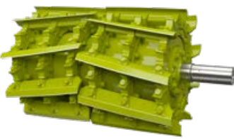
Longueur de coupe doublée avec la moitié des couteaux pour l'utilisation sans éclateur.
