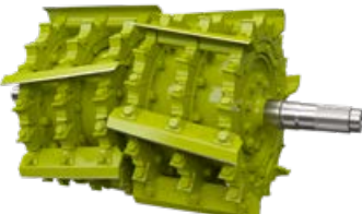
Un tiers des couteaux (uniquement avec le V36) pour les très grandes longueurs de coupe avec éjection symétrique du fourrage.
