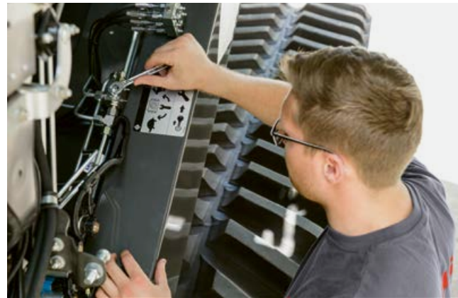
Ручное переключение двух диапазонов частоты вращения понижающего редуктора молотильного барабана выполняется с помощью гидравлического клапана.
