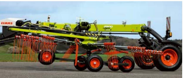
Эффект реактивного самолета: ротор ведет себя при подъеме или опускании, как самолет при взлете или посадке.
