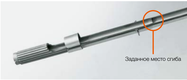
Максимальная защита: в случае столкновения граблиныгибаются в заданной точке.
