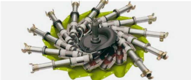
Надежность и отсутствие техобслуживания: главный компонент LINER — это лекало, работающее в масляной ванне.
