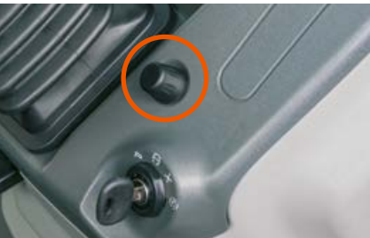
U kunt eenvoudig door het menu navigeren met behulp van de draaiknop die zich naast de stuurkolom bevindt.
