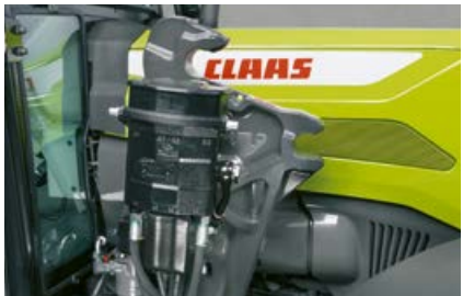
FITLOCK systeem voor snel aan- en afkoppelen en MACH snelkoppelingen voor elektrische en hydraulische verbindingen.
