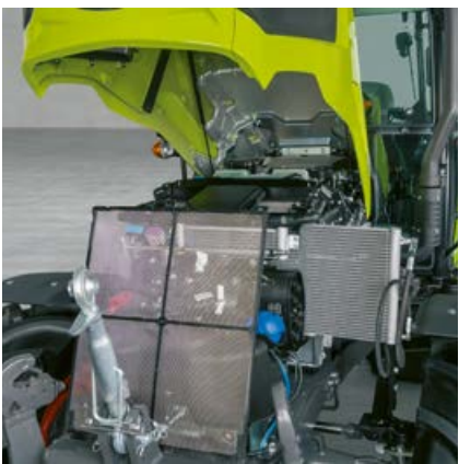
De radiator kan in een handomdraai naar buiten worden getrokken. De koelkorf kan voor controle en reiniging worden verwijderd.
