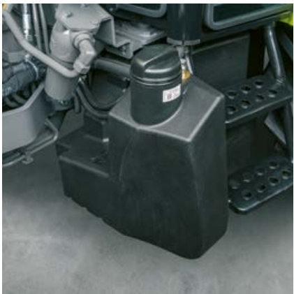
De dieseltank van 105 liter en AdBlue-tank van 10 liter zorgen ervoor dat er ook op lange werkdagen zonder onderbreking kan worden doorgewerkt.
