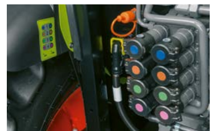
De aansluitingen aan de achterzijde zijn dankzij hun kleurcodering en de aangebrachte stickers eenvoudig te herkennen.
