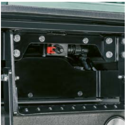
De accuschakelaar bevindt zich bij de linker opstap.
