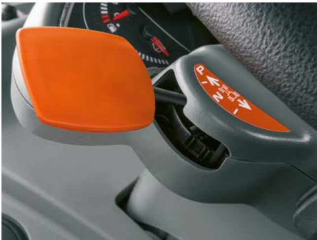
REVERSHIFT omkeerschakelhendel met elektronische parkeerrem leverbaar
