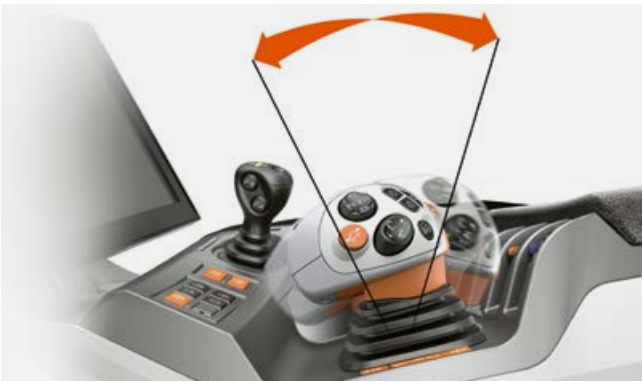
Progressieve bediening dankzij CMATIC traploze transmissietechnologie
