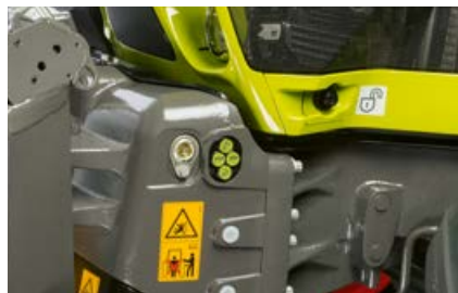
Externe bediening van de fronthefinrichting en een regelventiel (afhankelijk van de uitvoering).
