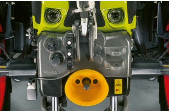
De aansluitingen voor een regelventiel en een vrije retour bevinden zich aan de fronthefinrichting.
