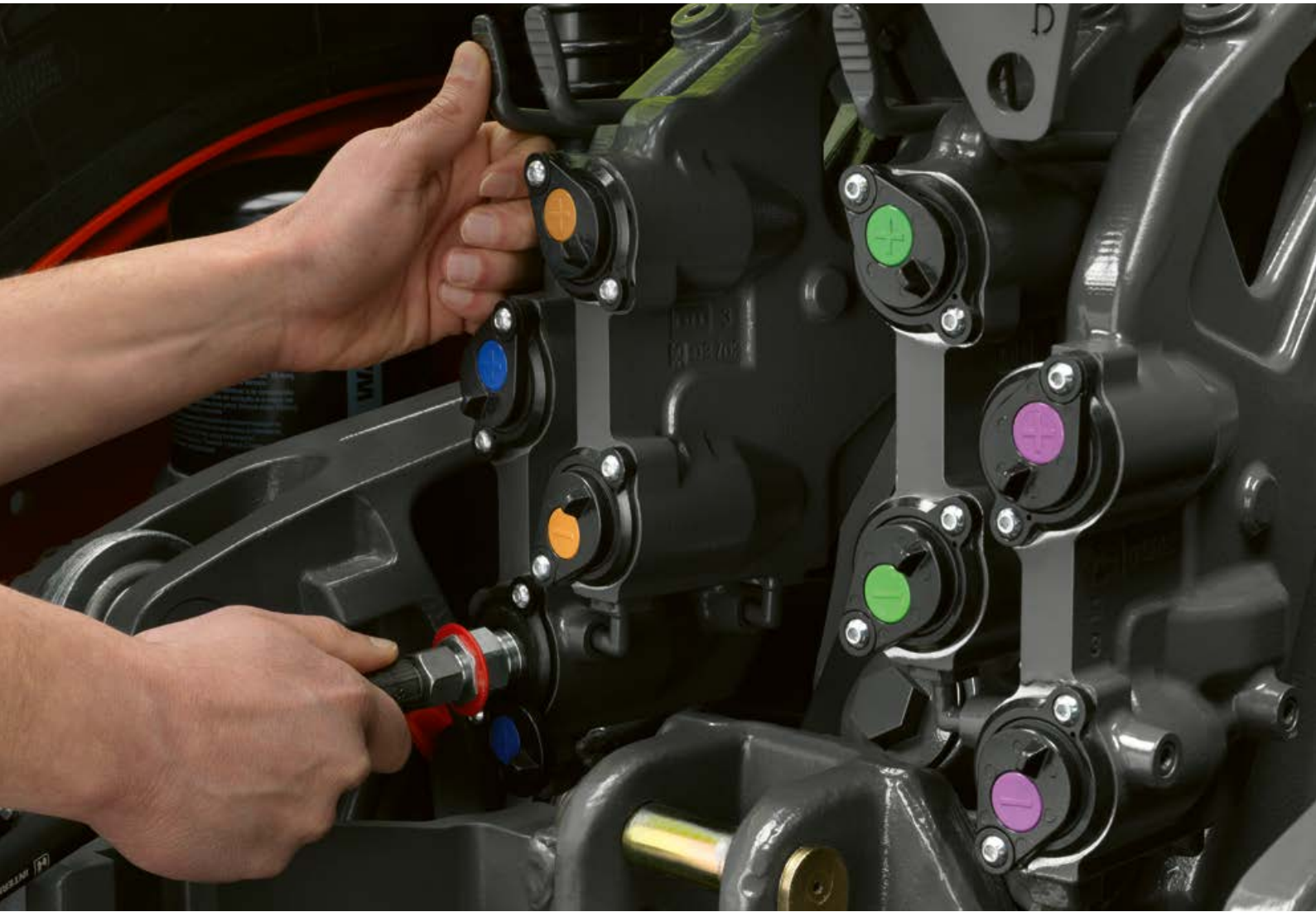
De aansluitingen voor een regelventiel en een vrije retour bevinden zich aan de fronthefinrichting.
