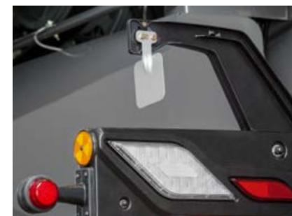
Sensor der automatischen Wurfrichtungsanpassung
