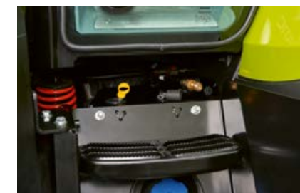
Z lewej strony na wejściu znajduje się przyłącze sprężonego powietrza.
