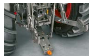
Alternatywnie zamiast zaczepu transportowego dostępny jest Pick Up Hitch.
