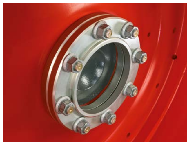
Przestawialne pierścienie dopasowujące rozstaw śladów lub opcjonalnie osie z suwliwymi piastami
