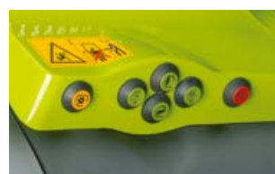
Zewnętrzne elementy obsługi tylnego podnośnika, WOM i wybranego gniazda hydraulicznego (tylko CEBIS)
