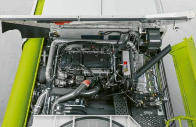
Mercedes-Benz OM 470 con 300 kW / 408 CV para LEXION 6700
