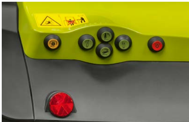
Comandi esterni per la presa di forza posteriore
