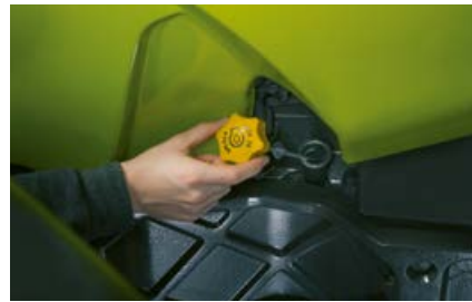
Possibilità di eseguire il controllo e il rabbocco dell'olio con il cofano chiuso
