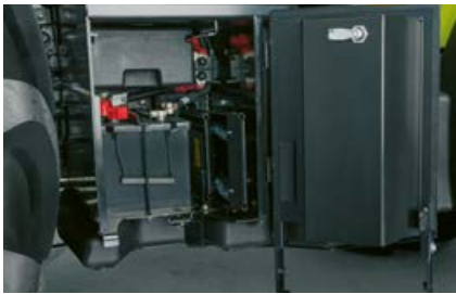
A destra della scaletta d'accesso si trovano la batteria e un vano portattrezzi, entrambi ben accessibili.
