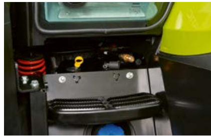
Una presa per l'aria compressa è disponibile a sinistra della scaletta d'accesso.
