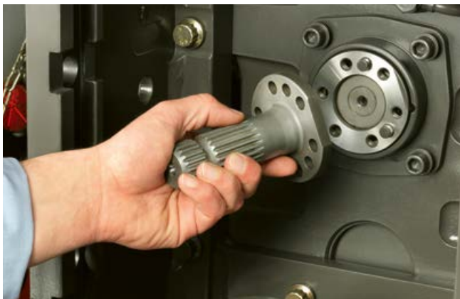
Facile sostituzione del codolo della presa di forza
