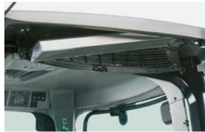
Facile accesso al filtro dell'aria nel tetto della cabina
