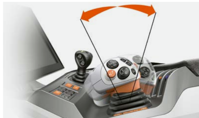
Commande progressive grâce à la technologie de transmission à variation continue CMATIC
